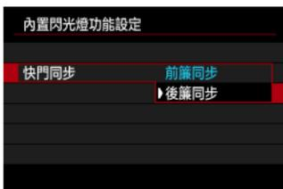
一般情況下，請將快門同步設為**[前簾同步]**以便閃光燈在開始曝光後立即閃光。設定為**[後簾同步]**並使用較慢的快門速度，可拍攝自然的主體運動軌跡影像，如汽車前燈等。
