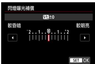
與調節曝光補償的方式類似，亦可以調節外接閃光燈的閃燈輸出。
