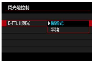
一般閃燈曝光時，請將其設為[**權衡式**]。如設為[**平均**]，閃燈曝光將對整個測光場景進行平均測光。
