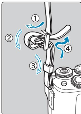
將相機帶末端從下面穿過相機的相機帶環，然後如圖所示將其穿過相機帶鎖扣。拉緊相機帶，確保相機帶不會從鎖扣鬆脫。
