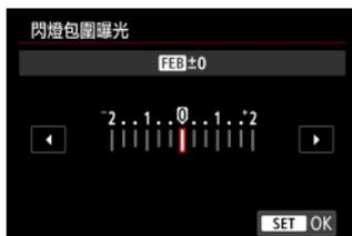
具備閃燈包圍曝光(FEB)功能的外接閃光燈可以在一次性拍攝三張相片時自動變更外接閃光燈輸出。
