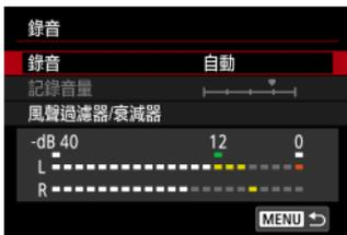
在記錄短片的同時，可以使用內置立體聲麥克風或外接立體聲麥克風記錄聲音。亦可自由調校聲音記錄音量。
