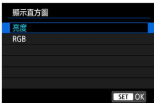
影像亮度直方圖顯示曝光等級分佈情況及整體亮度。RGB直方圖適用於檢查色彩飽和度及漸變情況。在[▶]：播放資訊顯示螢幕的左下角中顯示[INFO]時，透過按下<INFO>按鈕可以切換顯示的直方圖。
