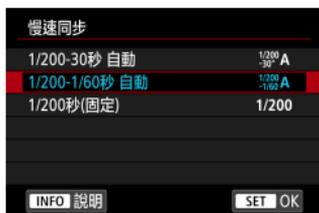
在<Av>光圈先決自動曝光模式或<P>程式自動曝光模式下可設定閃燈攝影的閃燈同步速度。
