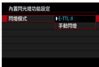
設定為[E-TTL II]，以在E-TTL II/E-TTL全自動閃燈模式下拍攝。
